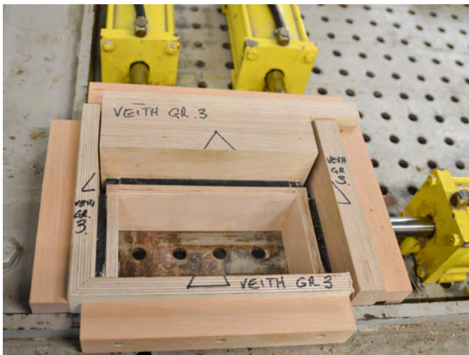
Dank der Vorrichtungen sitzen die Kistenwände fest in der Presse und kleben gut zusammen.
