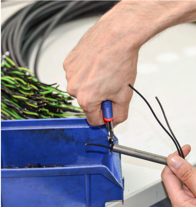
Durch die Metallröhre lässt sich die richtige Kabellänge leicht finden.
