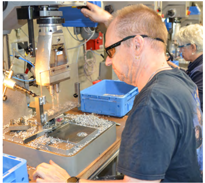
Die Vorrichtung hilft dabei, die Löcher an die richtige Stelle zu setzen.
