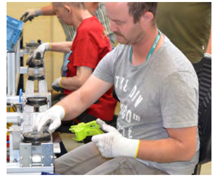
Mit der grünen Zange wird das Produkt angefasst.
