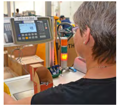
Wenn die Ampel grün leuchtet, ist die richtige Anzahl Schrauben im Karton.
